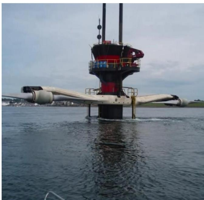
**Figura 15 - SeaGen S com turbinas emersas. Fonte: MCT (2017).**
